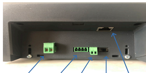
Anschluss 230VAC Zweitleser (optional) Relais Ein/Aus Schalter LAN/PoE Anschluss
